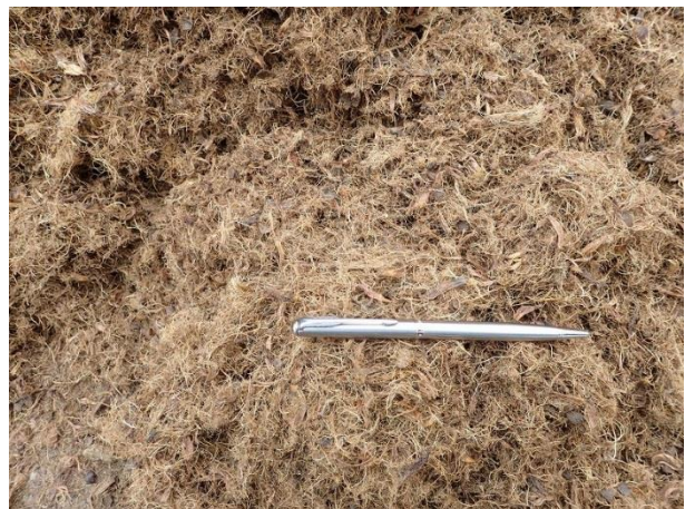
写真6 ボイラー燃料のMFとPKSの混合物
