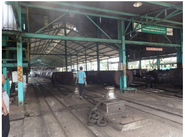
写真3 蒸煮工程の様子（レール上にFFBを積載した連結トロッコ，奥が蒸煮用オートクレーブ）
