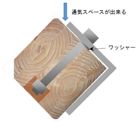
図3 ワッシャー挿入による通気の確保
