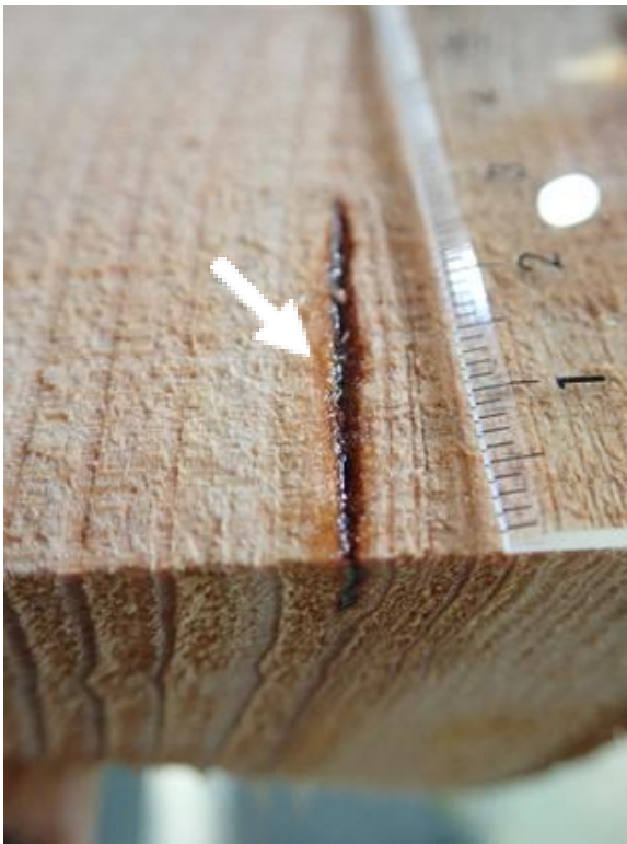
図1 カラマツ材中（上面：柁目面，垂直面：木口面）のヤニツボ（白矢印，目盛数値はcm）
