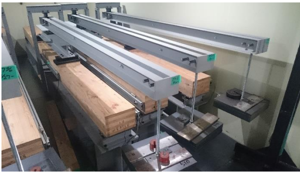
図3 実験で使用了長期荷重装置
