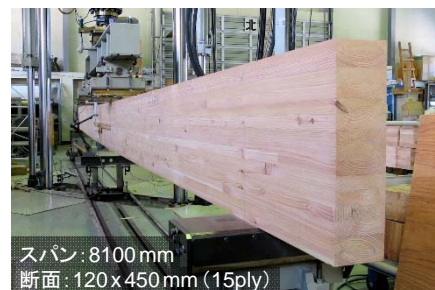
写真2 実大集成材の曲げ試験
