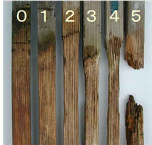
写真3 各被害度の目安
