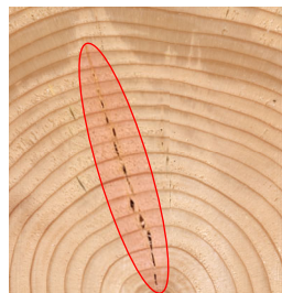
写真2 多年輪に跨がる割れ
