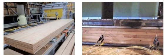
(a) 高周波プレス試験 (b) 接着層温度の計測 図1 CLT製造試験の様子
