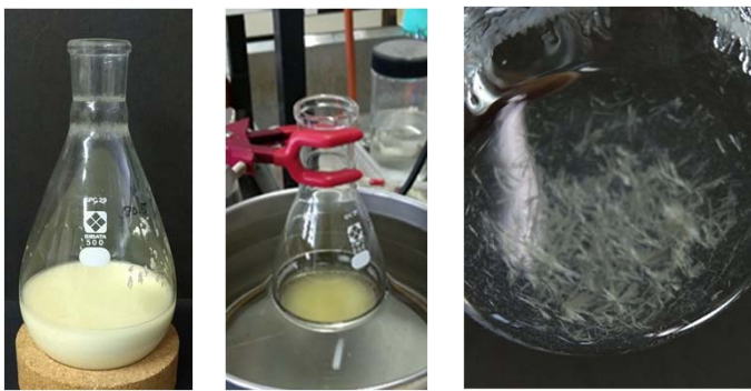
図8 粗ベツリン (左), 湯浴中でのエタノールへの溶解 (中), 再結晶化 (右) のようす
