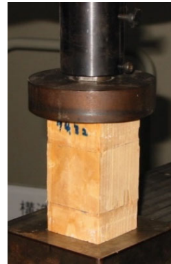
図1 木材の縦圧縮試験の様子
