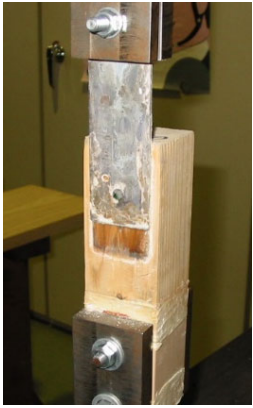
図3 釘接合部の一面せん断試験の様子
